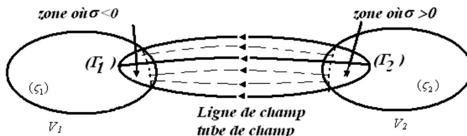
On appelle **tube de champ**, l'ensemble des lignes de champ s'appuyant sur une courbe fermée, telle que  $(\Gamma_1)$  tracée sur ( $\zeta_1$ ) ou  $(\Gamma_2)$  tracée sur ( $\zeta_2$ ).
