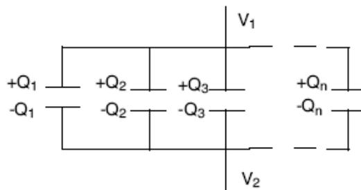
Soient  $n$  condensateurs mis **en parallèle** et portés à la même tension
